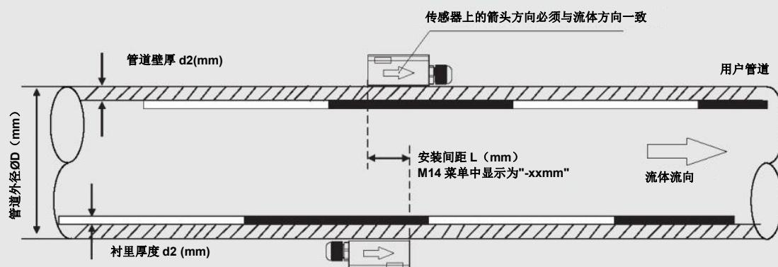
外夹式传感器在小口径管道上的 Z型安装示意图
