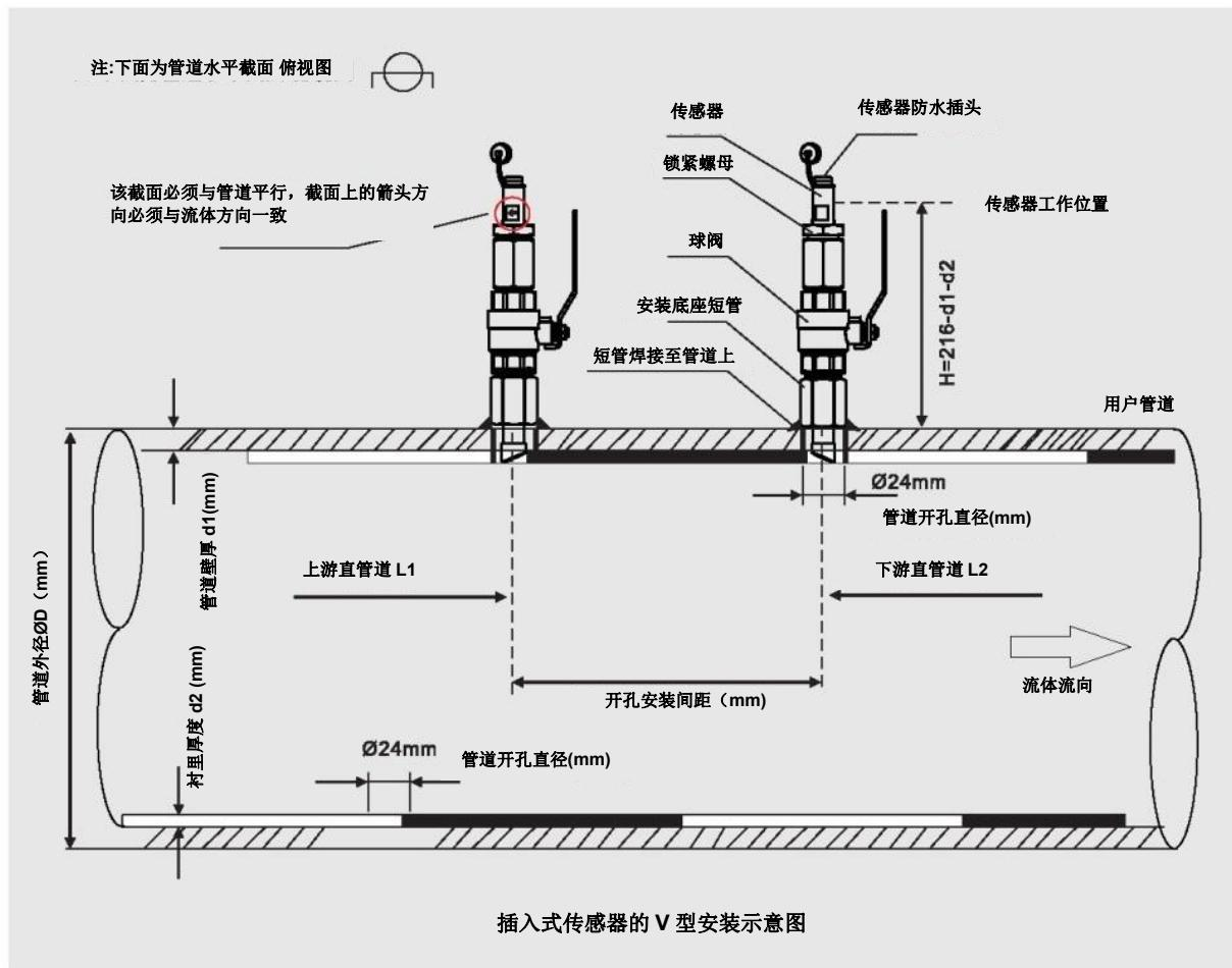
插入式传感器的 V 型安装示意图
