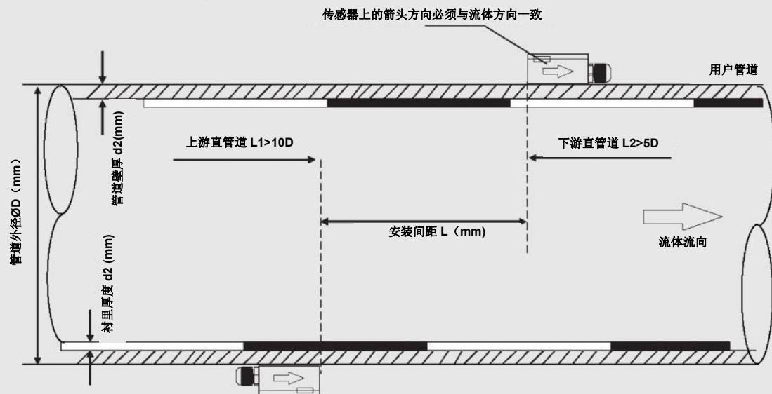
外夹式传感器 Z 型安装示意图
